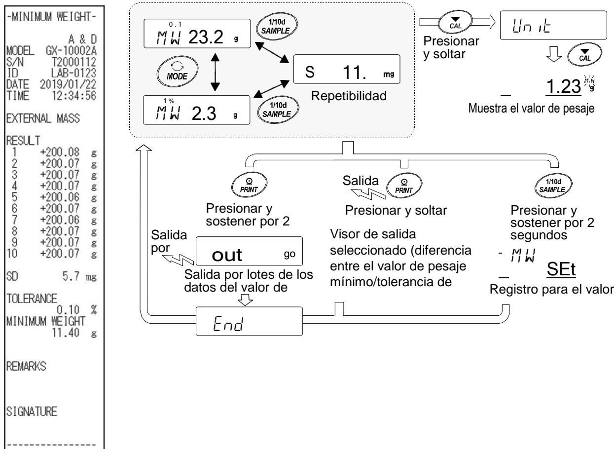
18. Presionar la tecla **PRINT** para la salida de repetibilidad (SD) y el valor de pesaje mínimo (MW) seleccionados en el paso 17.
