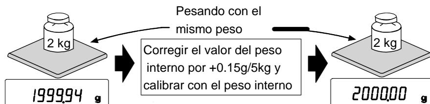
Después de realizar la calibración de un toque, colocar el peso externo en la balanza y verificar la cantidad de corrección.
