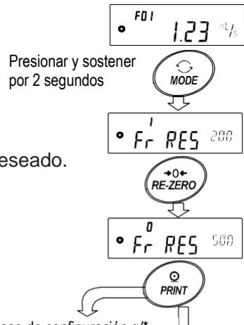
2. Presionar la tecla **RE-ZERO** para modificar el valor de configuración deseado.
