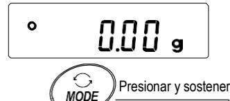
2. Presionar la tecla **MODE** para seleccionar la una velocidad de pesaje.
