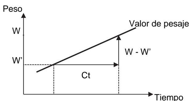
Para el tiempo de cálculo del flujo Ct, seleccionar manual / automático y configurar.
