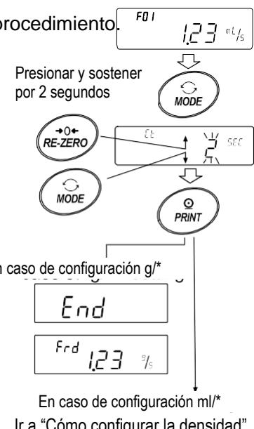
**Nota** La configuración de la unidad de tiempo (segundo(s), minuto(m) u hora(h)) se ingresa en "\*" de "g/\*" y "ml/\*". Para configurar los valores meta, consultar el "Manual Complementario de la función de medición de flujo de la serie GX-A/GF-A".
