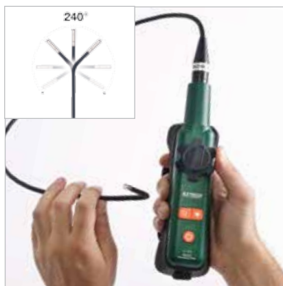
La tête de caméra (diamètre 6 mm) est articulée sur 240° pour améliorer la vision.
