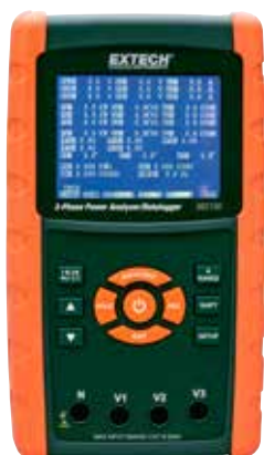
Le modèle 382100 comprend des sondes à pince 1200 A
