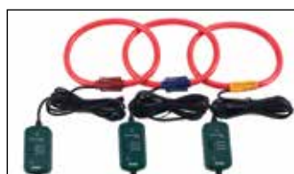
PQ34-30 : Sondes (600 mm) à pince ampèremétrique souple 3000 A, pour enlancer les barres omnibus.
