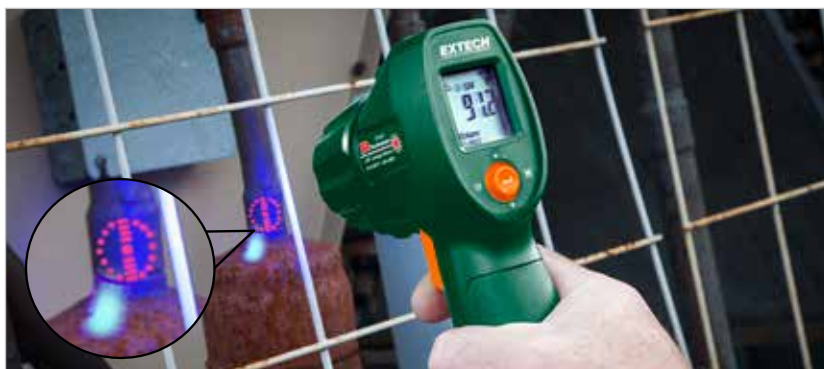
Guide laser indiquant la cible et détection UV d'une fuite de réfrigérant
