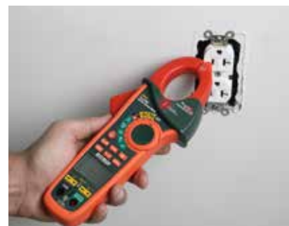
Détection de tension sans contact
