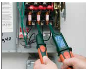
Ce testeur de tension multifonction mesure la tension dans les prises et teste l'ordre des 3 phases. Il comporte une lampe de poche.
