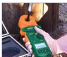
Vérification de la résistance des grilles de terre de tours de communication cellulaire
