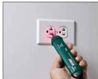
Vérification de la tension dans les coupe-circuit et les prises
