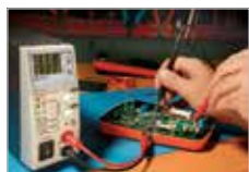
Alimentation CC à intensité limitée pour l'étalonnage et les réparations électroniques
