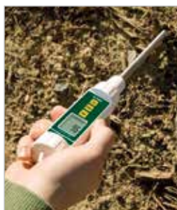
Comprend une sonde en acier inoxydable de 20 cm
