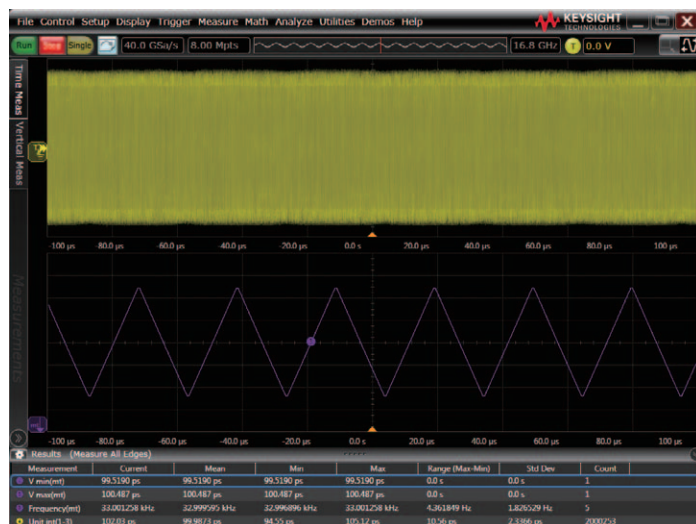
測定値トレンド表示（測定値の時間的変動）を使用してSSC特性を評価した例
