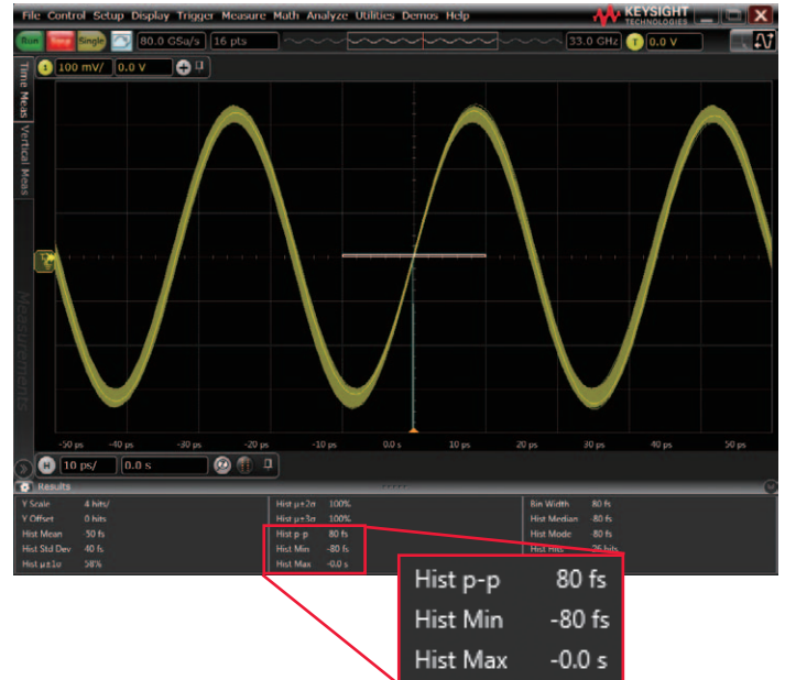
100 fs未満のジッター測定フロア(30 GHzの入力正弦波で80 fs)。
