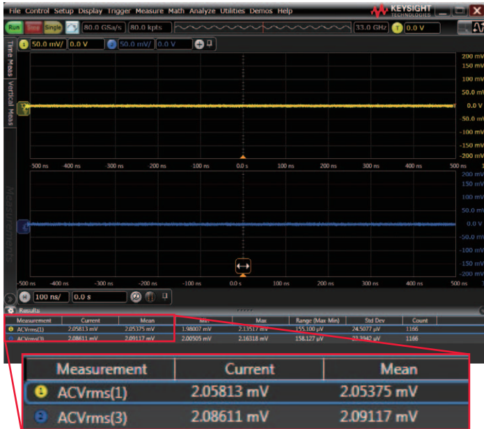
33 GHzのフル帯域幅でも極めて低ノイズ(50 mV/divで2.10 mV)。
