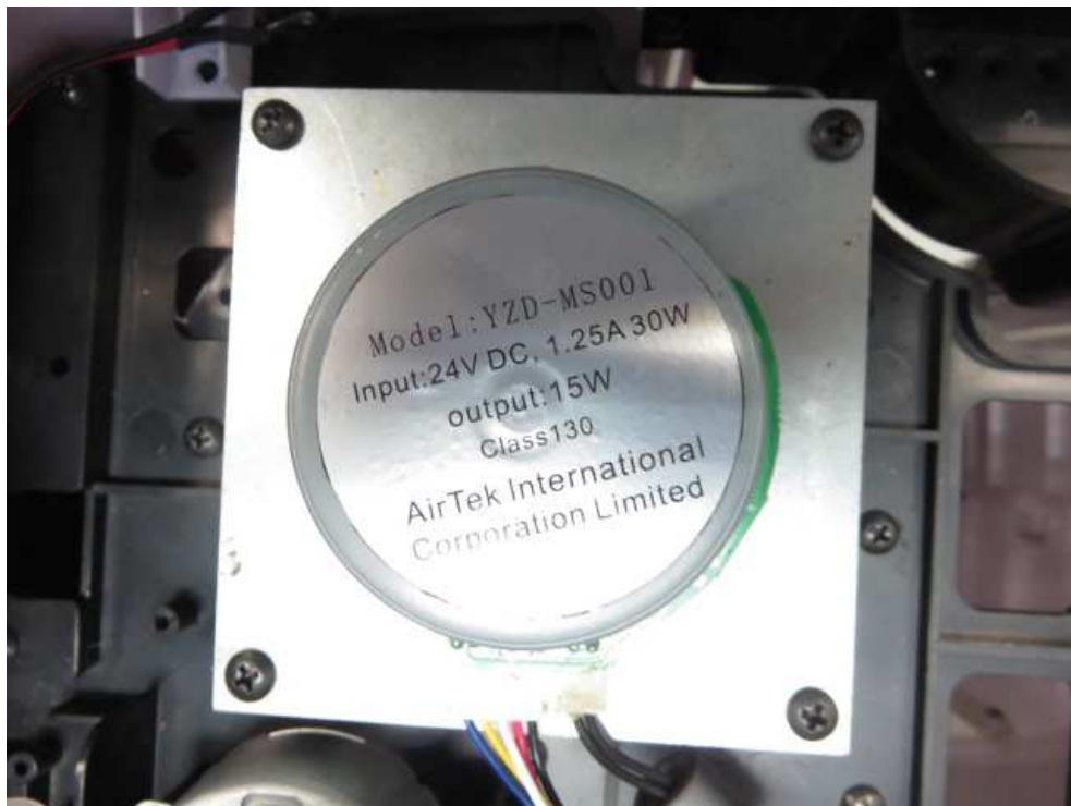
Fan motor view
