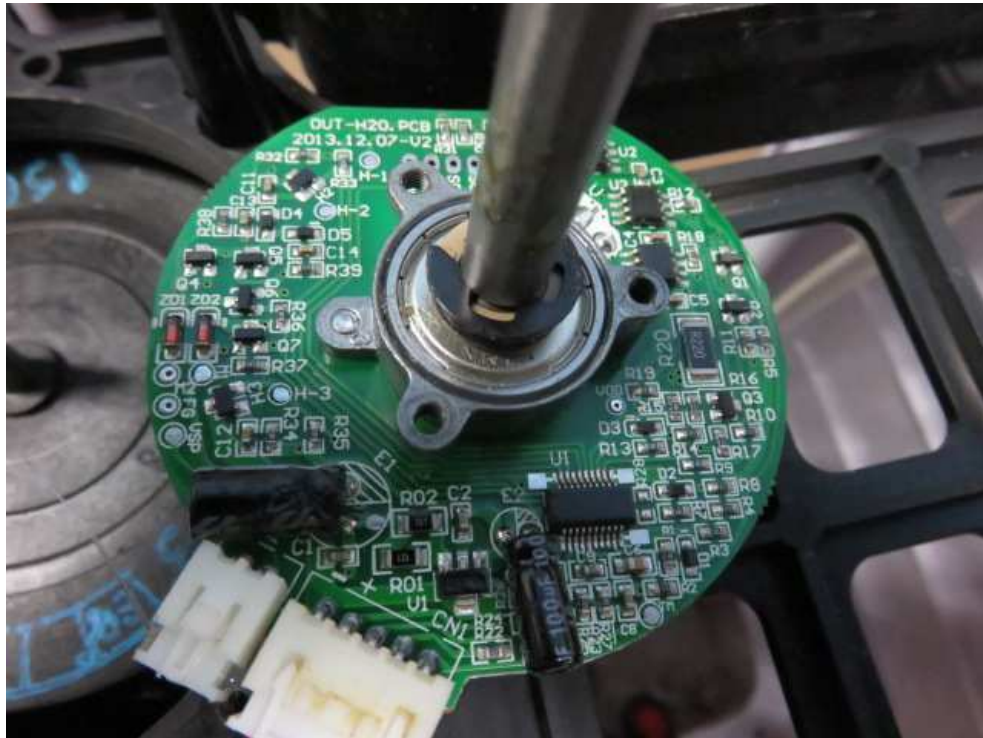
Fan motor PCB
