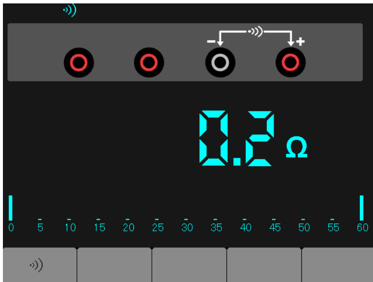
Figura 7-4 Medición de continuidad
