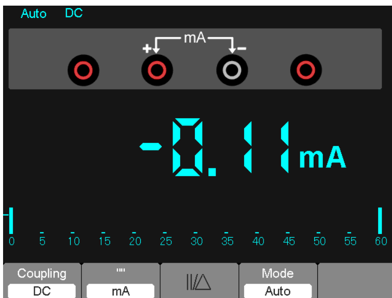
Figura 7-8 Medición de corriente CD para 600 mA
