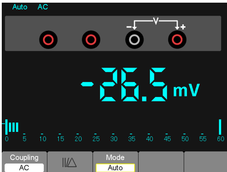
Figura 7-7 Medición de voltaje CA
