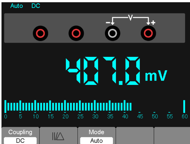
Figura 7-6 Medición de voltaje CD
