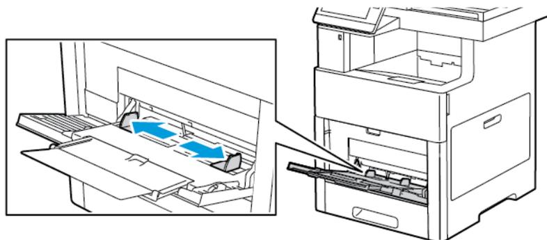
4. Doble las hojas hacia atrás y hacia delante y airéelas. A continuación, alinee los bordes de la pila en una superficie plana. Este procedimiento separa las hojas que estén pegadas y reduce la posibilidad de que se produzcan atascos.
