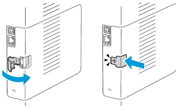
8. Conecte la impresora al equipo con un cable USB o a la red con un cable Ethernet.
