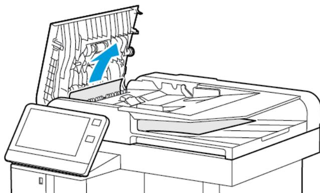
2. Si el papel está atascado en el alimentador automático de documentos a doble cara de una sola pasada, abra la cubierta del cristal de exposición.
