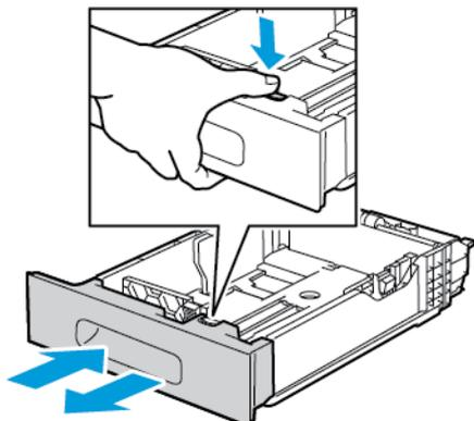
4. Para ajustar la bandeja para papel más largo, sujete la parte posterior de la bandeja con una mano. Con la otra mano, presione el enganche de liberación situado en la parte delantera de la bandeja y tire de los extremos hacia fuera hasta que se enganchen.
