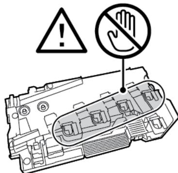
5. Coloque el cartucho de residuos de t ner sobre una superficie plana, con las aberturas hacia arriba.
