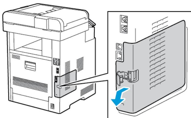
4. En el interior de la impresora, pulse la palanca de liberación hacia la parte delantera de la impresora. Mantenga la palanca de liberación en esta posición y extraiga con cuidado el adaptador de red inalámbrica de la impresora.
