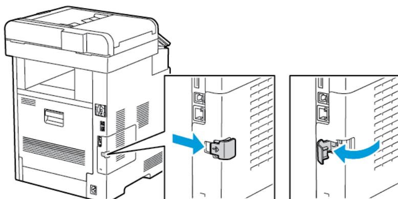
3. Para extraer la cubierta, deslícela hacia la parte posterior y luego hacia fuera de la impresora.
