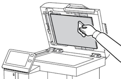
7. Para acceder al conjunto de lentes de escaneo de la cara 2, baje la cubierta de escaneo de la cara 2.
