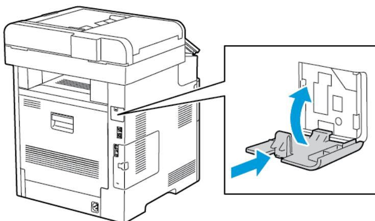
6. Coloque en su lugar la cubierta lateral izquierda y deslícela hacia la parte delantera de la impresora.
