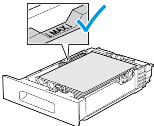
6. Ajuste las guías de anchura y longitud de manera que se ajusten al papel.
