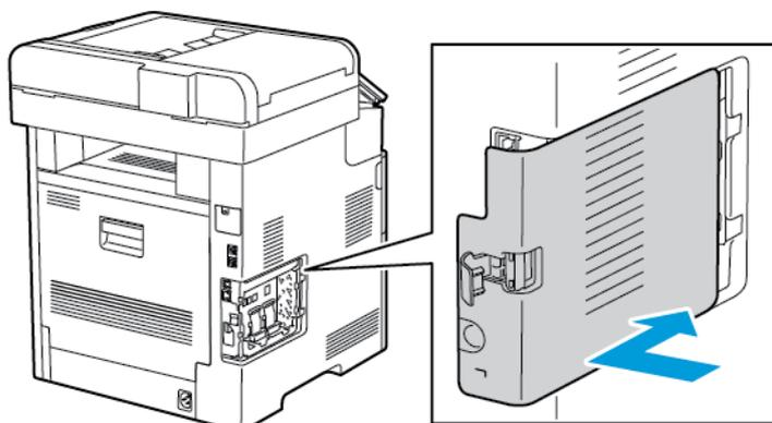
7. Para bloquear la cubierta, gire el tirador hacia la parte delantera de la impresora y luego empújelo hacia dentro hasta que encaje en la posición de bloqueo.
