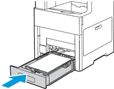
6. Inserte la bandeja especial en la impresora completamente.
