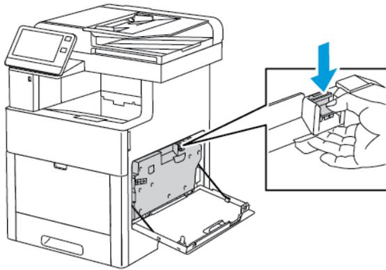
4. Para extraer el cartucho de desechos, baje la parte superior del cartucho y retírelo de la impresora. Para evitar que se derrame el tóner, mantenga las aberturas hacia arriba.
