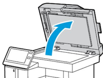
3. Para acceder al papel atascado, abra la cubierta de escaneado de la cara 2 y retire el papel atascado.
