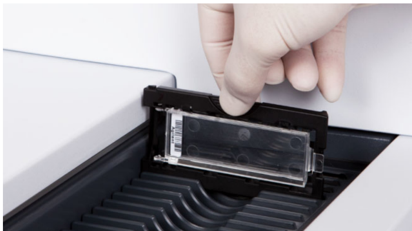
Kuva 44 Diapidikkeen asettaminen kasettiin
