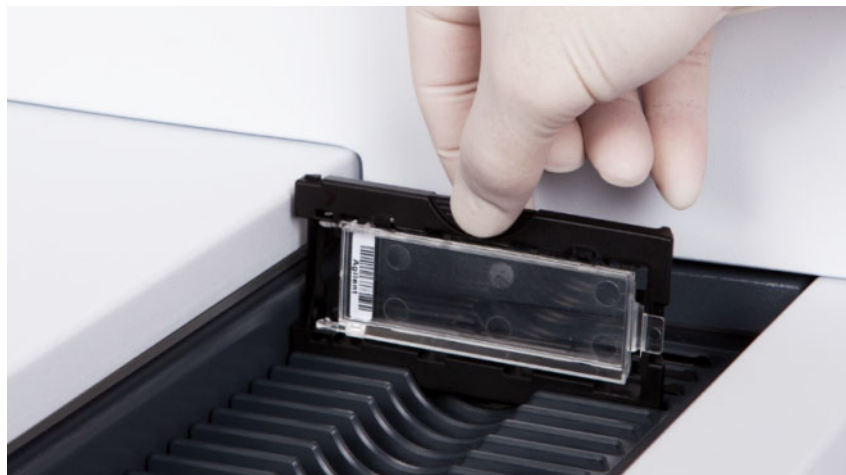
Figura 44 Insertar el portaplaclas en el cassette
