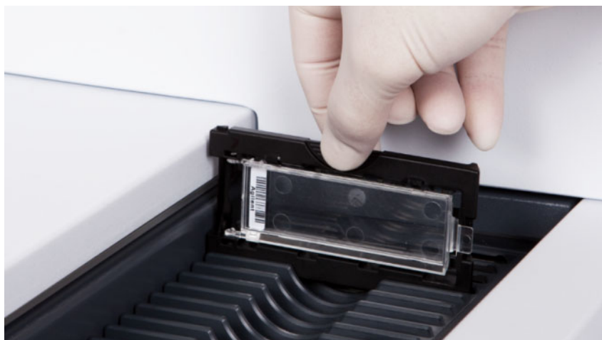
Фигура 44 Поставяне на държача за слайдове в касетата
