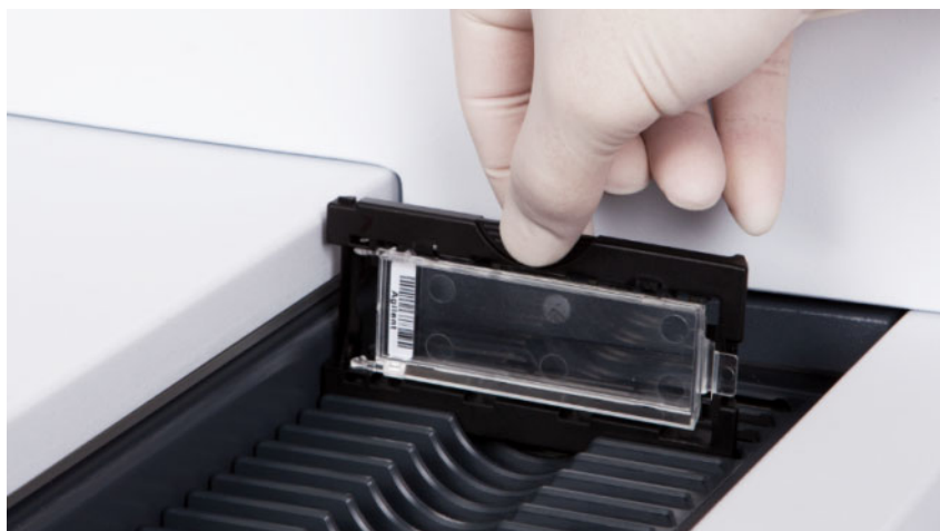
Obrázok 44 Vloženie držiaka sklíčka do zásobníka
