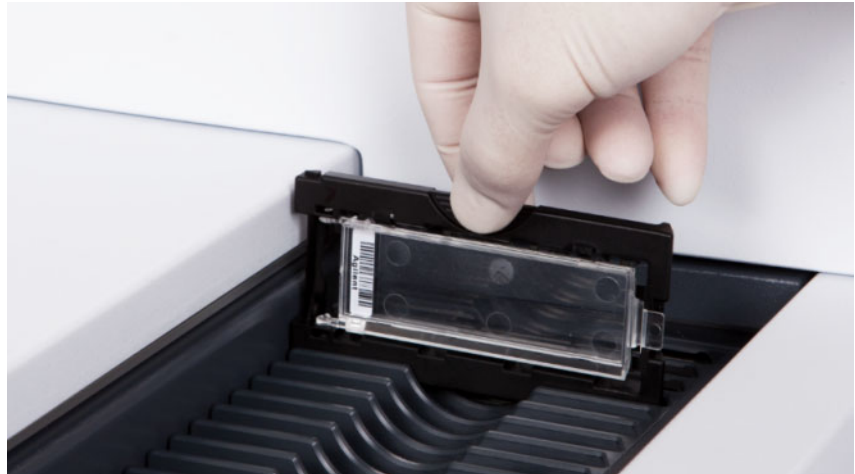
Rycina 44 Umieszczanie oprawy slajdu w kasecie.
