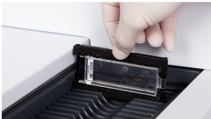
Figur 44 Indføring af glasholder i kassette
