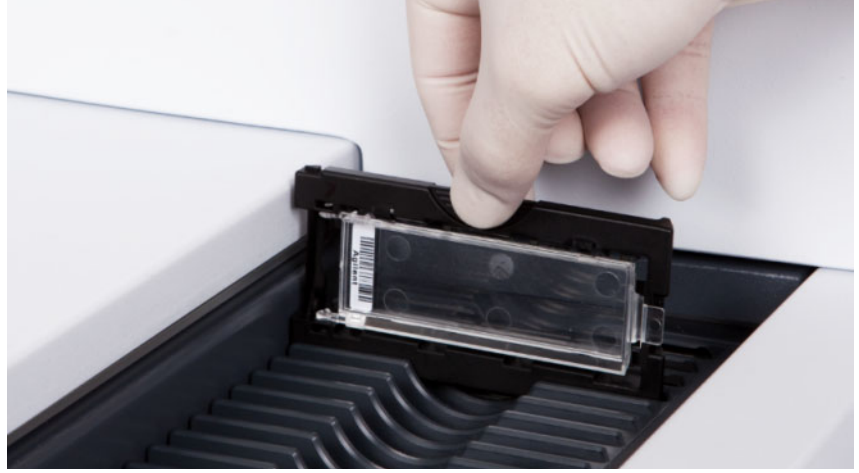
Şekil 44 Slayt tutucunun kasete yerleştirilmesi
