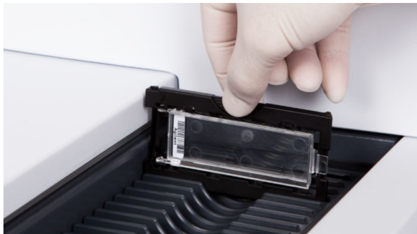
Abbildung 44 Einsetzen des Objektträgerhalters in die Kassette
