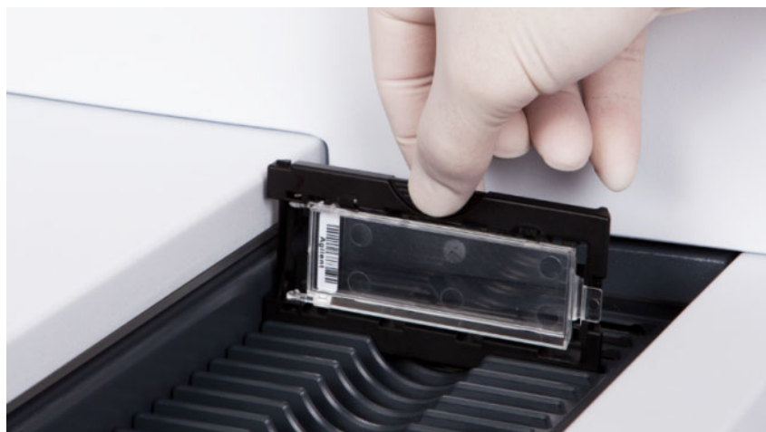
slika 44 Umetanje držača slajdova u kasetu
