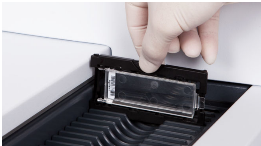
Obrázek 44 Vložení čipu do zásobníku
