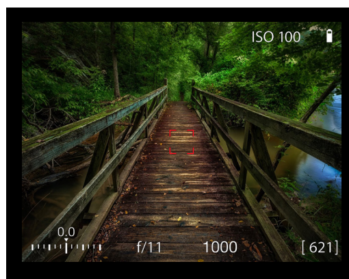
Indicatore AF rosso con una croce rossa. Analisi AF non riuscita per la messafuoco.
