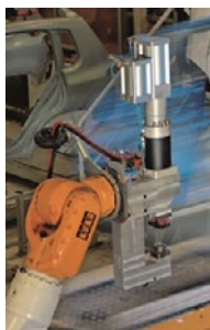
Afbeelding 11-15 Bekabeling naar bewegende elementen van de machine
