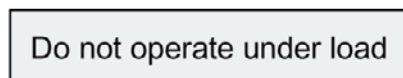
Afbeelding 13-22 Voorbeeld van een aanduiding die aangeeft dat de schakelaar niet onder belasting mag worden bediend
