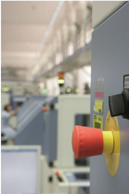
Afbeelding 10-11 Voorbeeld van een NOOD-UIT-drukknop in actie
