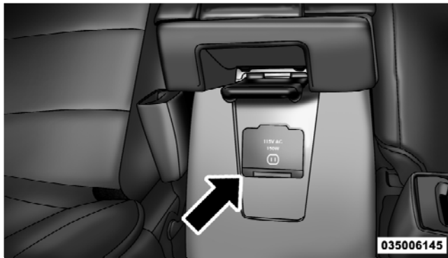
115-Volt Power Outlet
