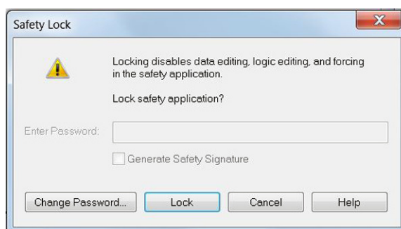
Figura 37 – Bloqueando o controlador com trava de segurança
