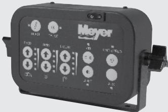
**VIBREUR** Le vibreur monté sur l'épandeur peut être activé en maintenant enfoncé le bouton VIB. Lorsque la fonction de vibration est activée, le voyant rouge à côté du bouton VIB s'allume. Il est possible de configurer la fonction de vibration pour fonctionner temporairement, en mode marche/arrêt ou avec « arrêt programmé ».
