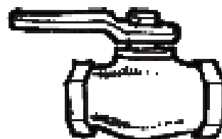
válvula de paso, llave de bola o esférica
