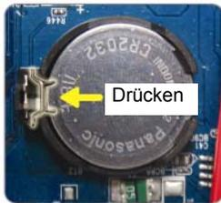
Schritt 5: Nehmen Sie eine neue Batterie und installieren Sie sie mit dem Schriftzug „CR2032“ nach obenweisend auf der Hauptplatine.
