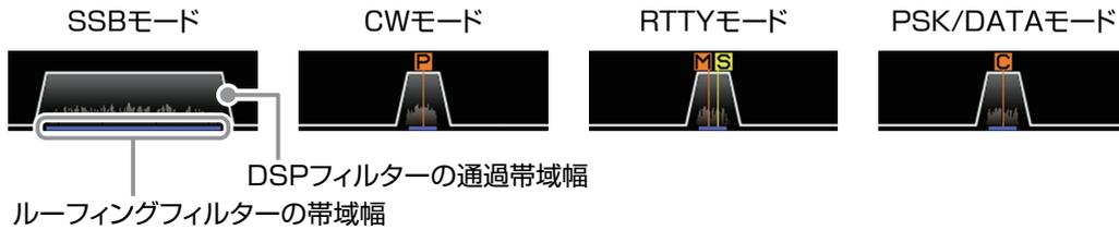
フィルター表示部にタッチすると、SHIFT、WIDTH、NOTCH、CONTOUR、APF の中から最後に使用した機能の設定値を表示して確認することができ、その機能のつまみをまわすと設定を変えることができます。そのまま2秒間放置するか、もう一度タッチすると元に戻ります。
