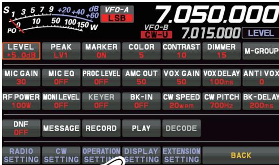
3. [DISPLAY] → [LED DIMMER] の順にタッチするか、[FUNC] ツマミをまわして項目を選択して [FUNC] ツマミを押します。
