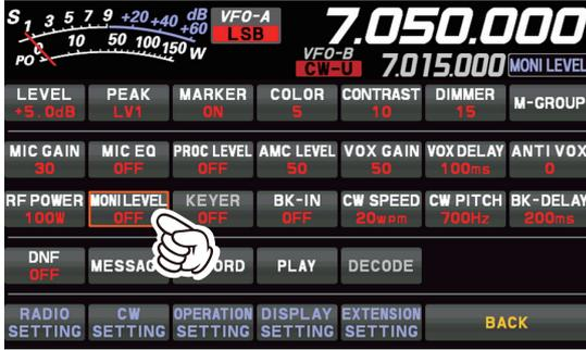
3. [FUNC] ツマミをまわしてモニターの音量をを調節します。
