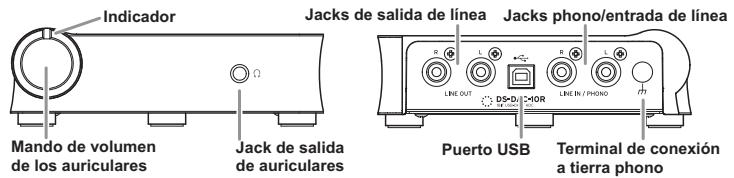
El DS-DAC-10R funciona con alimentación de bus a través del puerto USB; no necesita un adaptador de CA ni ninguna otra fuente de alimentación externa.
