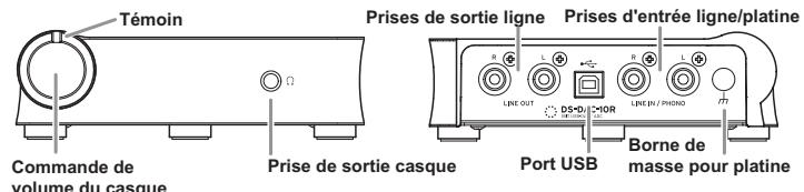
Le DS-DAC-10R est alimenté via le port USB ; il ne requiert donc aucun adaptateur secteur ou autre dispositif externe.
