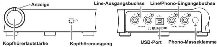
Der DS-DAC-10R wird über den USB-Port mit Busspannung versorgt und benötigt weder ein Netzgerät noch sonst eine externe Spannungsversorgung.
