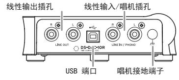
DS-DAC-10R 使用 USB 端口提供的总线电源; 不需要 AC 适配器或任何外部电源。
