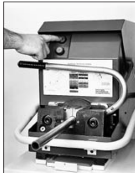
Fig. T16 – Parflange 1025 machine
