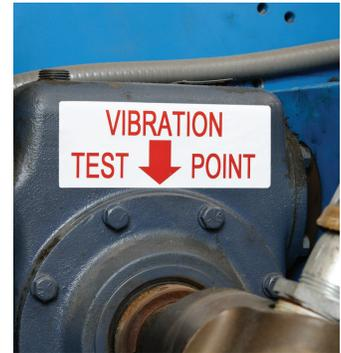
El uso de objetivos de mantenimiento predictivo asegura que las sondas de vibración y ultrasonido se posicionen para máxima repetibilidad, independientemente de quién haga la lectura.
