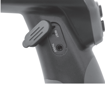
Şekil 9 - TV-ÇIKIŞ Jakı/Sıfırlama Düğmesi
