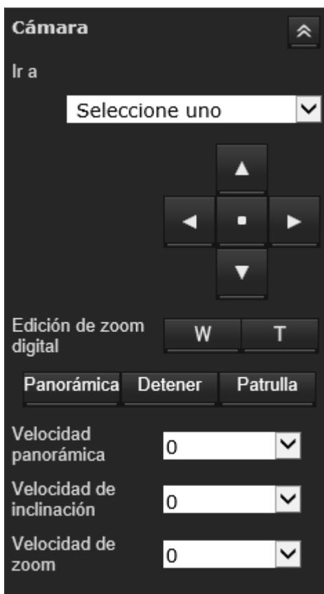
La cámara es compatible con los controles digitales de movimiento horizontal/vertical/zoom (e-PTZ). Desde este panel es posible mover la cámara en horizontal/vertical, situarla a la posición de inicio y aplicar zoom.
