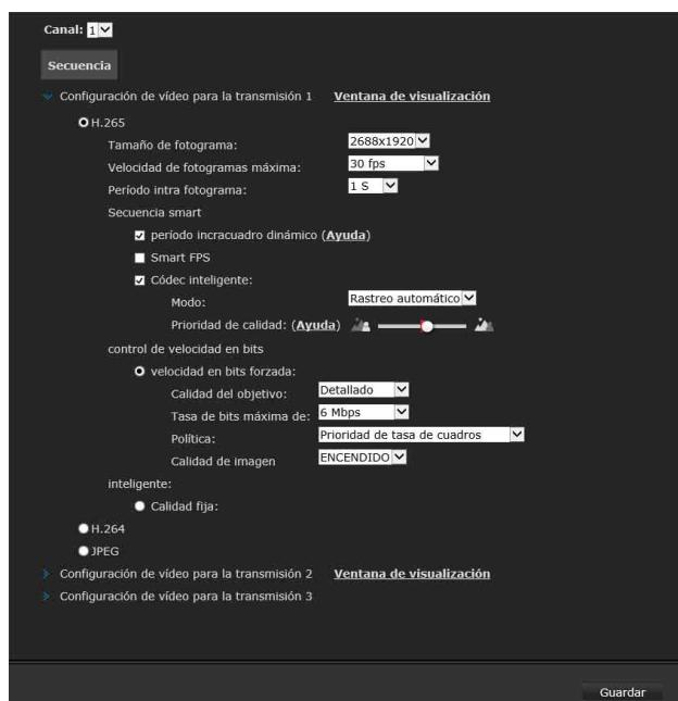
**Canal:** seleccione un canal (uno de los 4 sensores) antes de configurar ajustes. Estos 4 sensores pueden configurarse individualmente.
