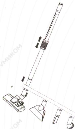
3. Раздвижную металлическую трубку можно регулировать по длине в зависимости от ситуации. Более тонкий конец трубы предназначен для установки щетки или насадки, которую следует ставить с небольшой силой для наиболее прочного крепления. Устройство можно использовать с насадкой для воды, скошенной насадкой, треугольной и другими насадками.
