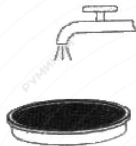
4. HEPA-фильтр допускается мыть водой прямо под краном для удаления поверхностного слоя пыли. Частоту мытья фильтра следует определять, исходя из нагрузки. Рекомендуется после каждой уборки слегка простучивать HEPA-фильтр во избежание негативного влияния скоплений пыли на производительность пылесоса. После каждой очистки перед началом использования необходимо убедиться в том, что все компоненты пылесоса полностью сухие.
