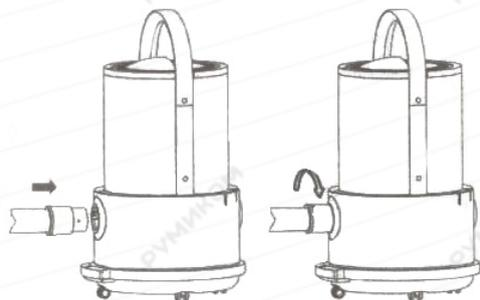
2. Ориентируясь на канавки всасывающего отверстия, подключите патрубок шланга к корпусу, вставив его в отверстие и слегка повернув по часовой стрелке до характерного щелчка;
