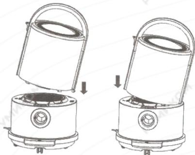
1. Слегка наклонив ведро, правой стороной вставьте его в соответствующую канавку на основании, затем с небольшим усилием вставьте левую сторону ведра в канавку на основании до характерного щелчка, после чего слегка поднимите сборку, чтобы убедиться в правильности крепления ведра к основанию;
