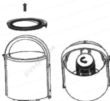
2. Снимите с ведра верхнюю крышку. Одной рукой возьмитесь за ручку, другой рукой держитесь за основание ведра, наклоните его для опустошения и избавления от содержимого, после чего поверните циклонную установку против часовой стрелки, чтобы извлечь ее.
