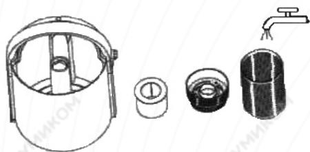
3. Циклонную установку, циклонные лопасти, поплавок и ведро промойте водой и высушите.
