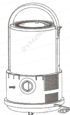
6. На задней стороне корпуса устройства есть нормально закрытое выдувное отверстие с портом для подключения. При необходимости использования функции воздуходувки в него можно подключить шланг и использовать его для направления мощного потока воздуха. При работе в режиме пылесоса выдувное отверстие находится в закрытом состоянии, его открытие происходит только при подключении патрубка шланга.
