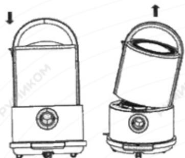
1. Нажмите на кнопку снятия ведра-пылесборника, слегка наклоните и потяните ведро вверх, чтобы отделить его от основания устройства.
