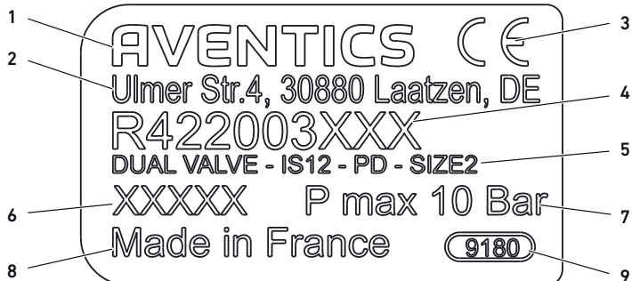
3 Typenschild | Plaque signalétique | Name plate | Targhetta dati | Placa de características | Typskylt 1: Firmenname | nom de la société | Company name | nome azienda | Nombre de la empresa | Tillverkarnamn 2: Firmenadresse | adresse de la société | Company address | indirizzo azienda | Dirección de la empresa | Tillverkarens adress 3: CE-Kennzeichnung | marquage CE | CE mark | marchio CE | Marcado CE | CE-märkning 4: Materialnummer | référence | Material number | codice | Número de material | Materialnummer 5: Typenbezeichnung | Désignation | Type designation | denominazione del tipo | Denominación de tipo | Typbeteckning 6: Fertigungsdatum | date de fabrication | Production date | data di produzione | Fecha de fabricación | Tillverkningsdatum 7: Maximaldruck | pression maximale | Maximum pressure | pressione massima | Presión máxima | Maximallt tryck 8: Herstellungsland | pays de fabrication | Country of manufacture | paese di produzione | País de fabricación | Tillverkningsland 9: Verantwortliches Werk | usine responsable | Responsible plant | stabilimento responsabile | Fábrica responsable | Ansvarig fabrik
