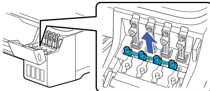
5. Voltee las tapas de transporte de modo que las partes redondas estén orientadas hacia abajo.
