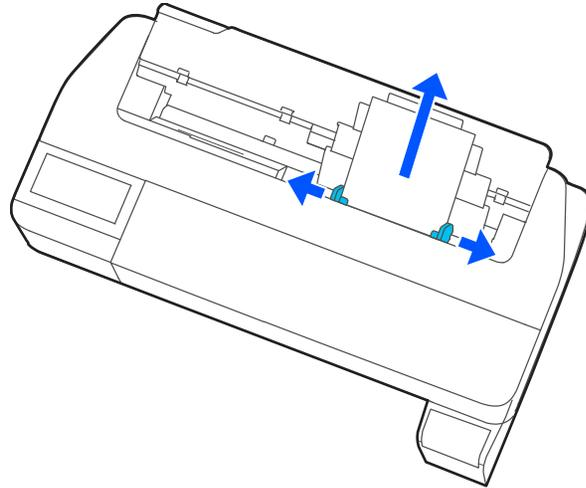
2. Baje y vuelva a meter las extensiones del soporte del papel y cierre el alimentador automático de hojas.
