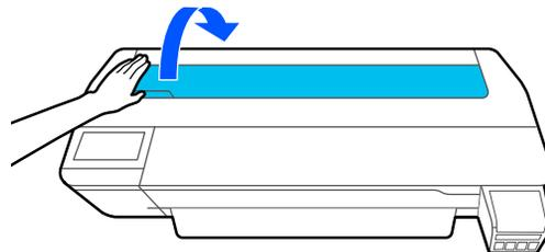
4. Incline el alimentador automático de hojas hacia atrás, luego tire de las extensiones del soporte del papel hacia arriba y hacia atrás.
