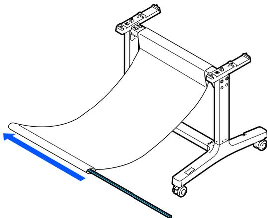
10. Inserte la parte superior de las varillas de soporte por las trabillas de la lona de la cesta y sujételas a las varillas de la cesta de papel.
