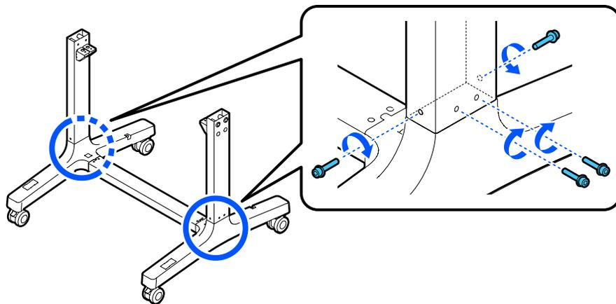
5. Empuje la lona de la cesta hacia adentro para que no se atrape entre la barra y las patas, luego conecte la barra a las patas, tal como se muestra a continuación.
