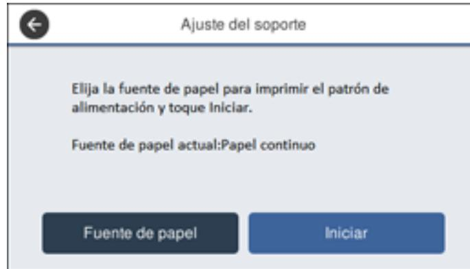
5. Si desea cambiar la fuente de papel utilizada para imprimir el patrón de ajuste, seleccione **Fuente de papel**. De lo contrario, seleccione **Iniciar** para imprimir el patrón de ajuste.
