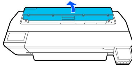
3. Seleccione **Quitar** en la pantalla LCD. El papel en rollo se rebobina automáticamente.
