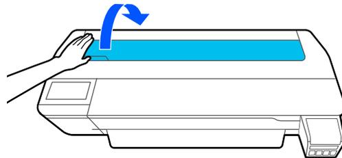
4. Cargue una hoja de papel con el lado imprimible hacia arriba y en posición vertical. Alinee el borde derecho del papel con la guía lateral derecha de la impresora y la línea de marca izquierda, según el tamaño de papel que está utilizando.
