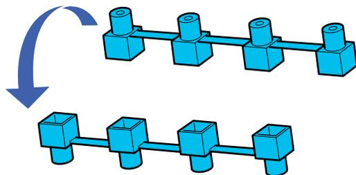
6. Coloque las partes redondas de las tapas de transporte, tal como se muestra a continuación.
