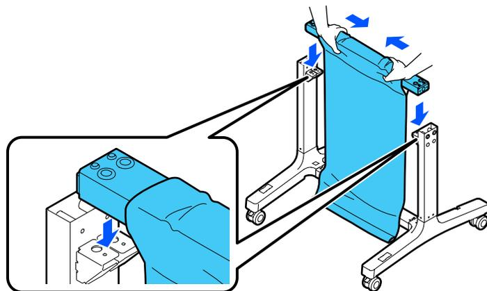
**Nota:** Compruebe que las etiquetas L (izquierda) y R (derecha) en la cesta de papel estén orientadas correctamente con las etiquetas L y R en las bases de las patas.
