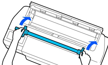
10. Cierre la cubierta del papel en rollo y la cubierta del alimentador de hojas sueltas.
