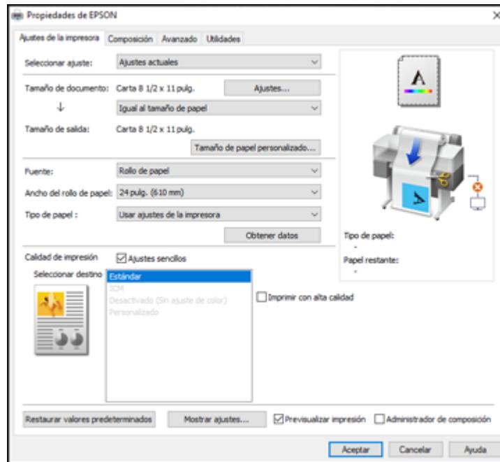
3. Seleccione los ajustes de impresión que desea utilizar como los ajustes predeterminados en todos los programas de Windows.
