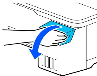
3. Abra todas las tapa de los tanques de tinta.
