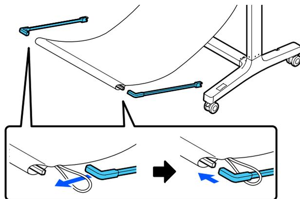
11. Inserte los extremos de las varillas de soporte de la cesta en los orificios ubicados en las bases de las patas.
