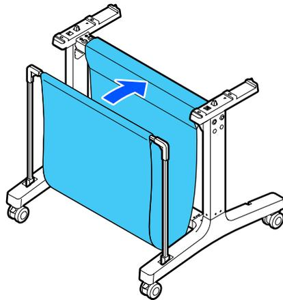
13. En la parte posterior de la cesta de papel y el soporte, sujete las trabillas de la lona de la cesta a los ganchos de las bases de las patas, tal como se muestra a continuación.
