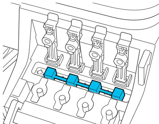
7. Cierre las tapas de los tanques de tinta firmemente para que queden planas.
