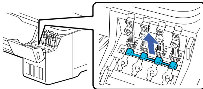
5. Voltee las tapas de transporte de modo que las partes cuadradas estén orientadas hacia abajo.
