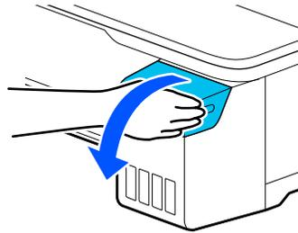
3. Abra todas las tapas de los tanques de tinta.
