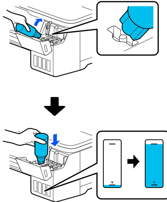
**Nota:** Consulte la etiqueta de colores situada en la unidad de tanques de tinta para identificar el color de cada tanque. No inserte las botellas por la fuerza; las botellas están diseñadas para funcionar exclusivamente con el tanque de tinta del color correspondiente.
