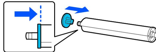
10. Coloque el rollo de papel en los soportes del huso dentro de la impresora con el tope negro del huso en el lado derecho.
