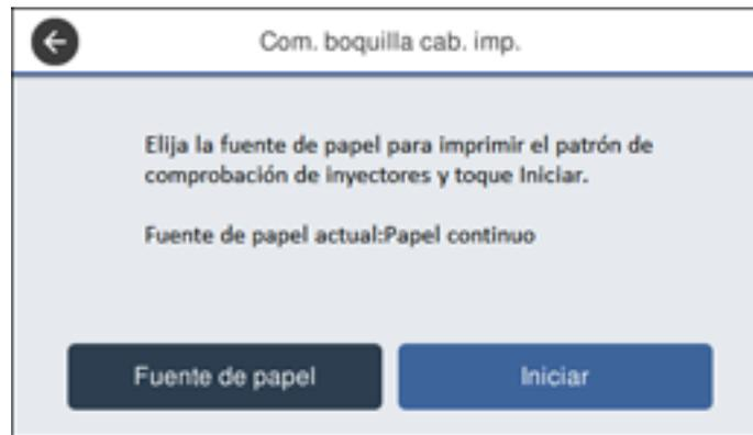
4. Si desea cambiar la fuente de papel utilizada para imprimir el patrón de prueba de los inyectores, seleccione **Fuente de papel**. De lo contrario, seleccione **Iniciar** para imprimir el patrón.
