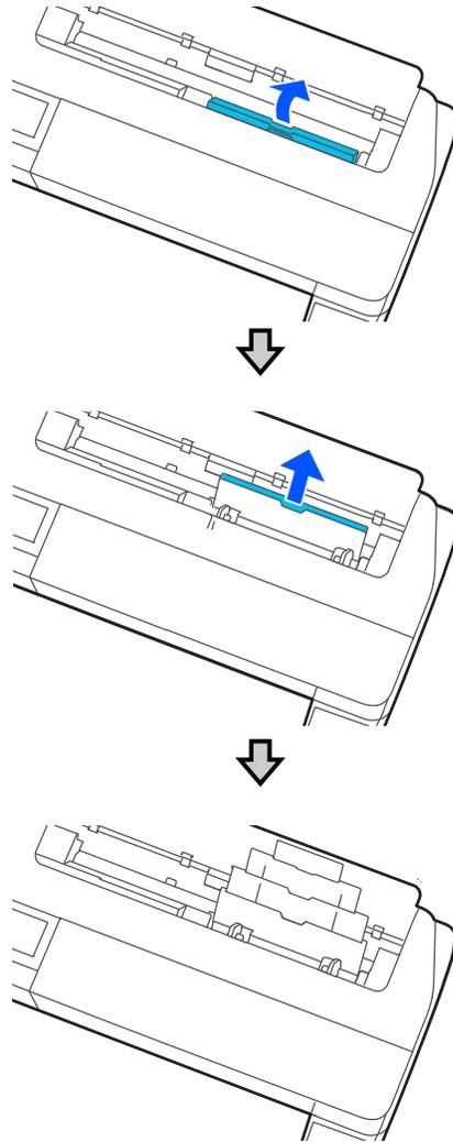
5. Deslice las guías laterales hacia las orillas.
