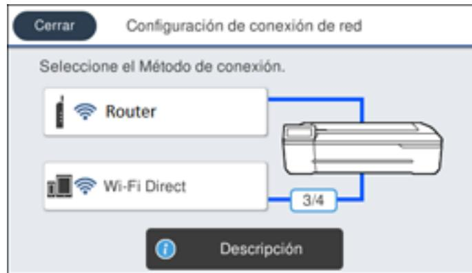
3. Seleccione **Router** > **Iniciar configuración** o **Cambiar configuración** > **Otras** > **Deshabilitar Wi-Fi**.
