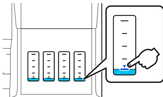
**Nota:** El producto tiene un sistema de alerta que le indica cuando el nivel de tinta está bajo. La precisión del sistema se basa en que los tanques de tinta sean rellenados correctamente. El producto no puede medir los niveles de tinta directamente, sino que calcula la cantidad de tinta restante mediante el conteo
