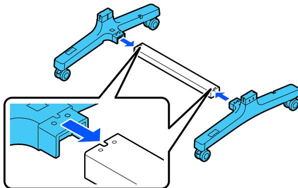
2. Utilice la llave Allen para colocar 8 tornillos (4 en cada lado) en los orificios ubicados en la barra de soporte y las bases.
