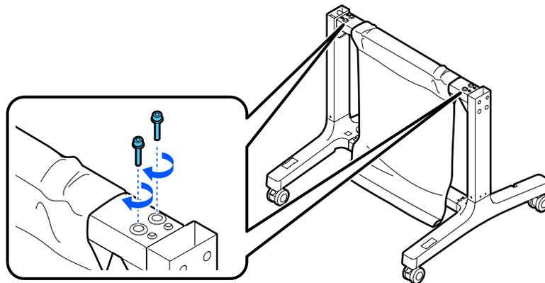
7. Compruebe que las etiquetas L y R en los soporte de montaje estén orientadas correctamente con las patas izquierda y derecha y adjúntelas, tal como se muestra a continuación.
