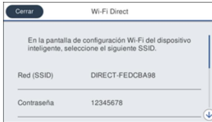
4. Utilice su computadora o dispositivo inalámbrico para seleccionar el nombre de la red Wi-Fi (SSID) que aparece en la pantalla LCD, luego introduzca la contraseña que aparece.
