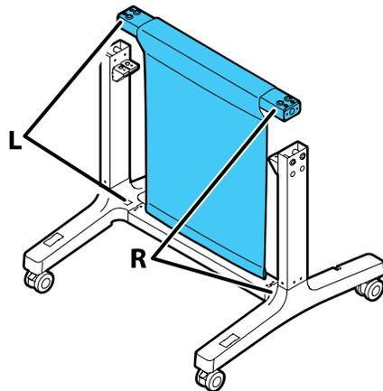
6. Coloque 4 tornillos (2 en cada lado) en los orificios ubicados en la barra de la cesta de papel para fijarla a las patas.
