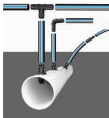
Las cuñas de sujeción aseguran la hermeticidad de la conexión
