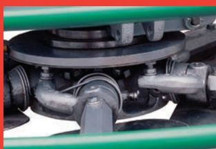
Los conjuntos de cruceta tienen aspas y cubos de araña de larga duración
