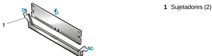
Figura 3. Desmontaje de un módulo RIMM
