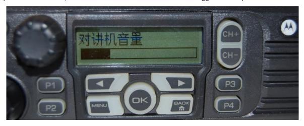
10. 測試 GATEWAY 的車用 RADIO 音量可否驅動 ZELLO 的 VOX 功能,音量由 1/4 刻度開始 調整,由外部的 RADIO 講話,慢慢的調整音量至適當的音量,並且可以驅動 ZELLO 的 VOX 功能即可。
