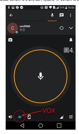
7. GATEWAY 另一端插頭是連接到 RADIO。這時可以外部行動電話的 ZELLO 與 GATEWAY 的 ZELLO 先進行講話測試。如果外部行動電話的 ZELLO 的聲音無法讓 RADIO PTT 時, 請將 GATEWAY 連接的行動電話音量再調大或是來源信號的 Gain 值再調大, 再測試外部行動電話的 ZELLO 的聲音可以驅動 RADIO 的 PTT。
