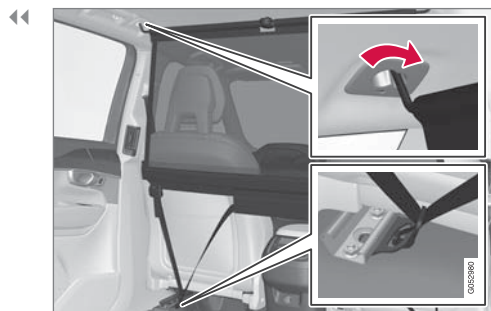
前段安裝位置。
