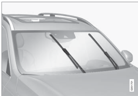
位於維修位置的雨刷片。
