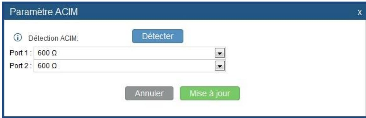
**Figure 67: Paramètres Ports FXO ACIM**
