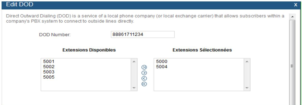
**Figure 32: Sélection de l'extension DOD**
