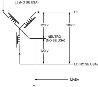
⚠️ Precaución: La patilla que no se utiliza (L3 en la ilustración) debe permanecer abierta. No debe conectarse a una barra de neutro ni a masa de tierra.
