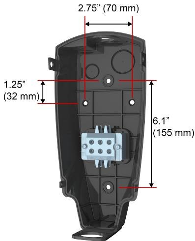
1. Utilice la plantilla de cartón y un nivel como guía para marcar la ubicación en la pared de los tornillos de fijación.
