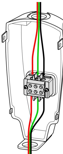
La siguiente ilustración muestra un ejemplo del cableado para el soporte del perfil inferior.
