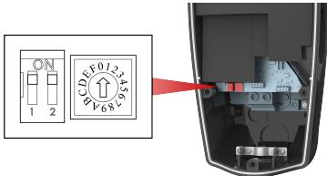
**Aviso:** La alimentación DEBE estar DESCONECTADA antes de ajustar o cambiar los interruptores DIP o giratorios. El sistema no reconocerá el cambio de estos interruptores con la alimentación CONECTADA y será peligroso debido a la posibilidad de descargas eléctricas.
