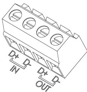
1. Forme una red conectada en margarita conectando los cables de OUT a IN y
