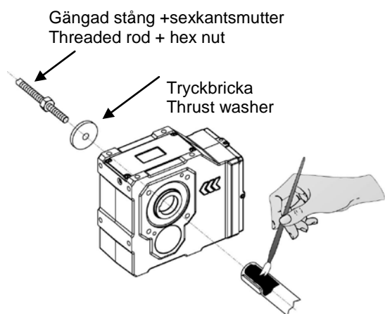
Bild 1: Fastdragnin av kundaxel med eller utan ansats på axeln Fig. 1: Tightening the customer shaft with or without shoulder
