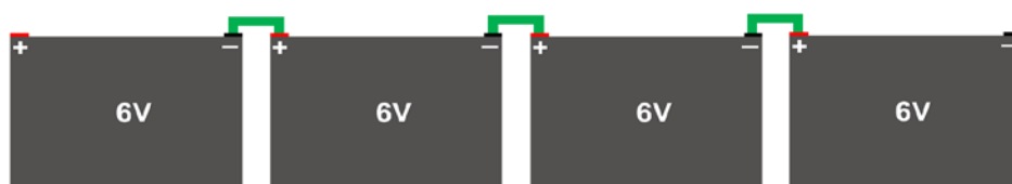
Figura 9.5 Cuatro baterías de 6V conectadas en serie
