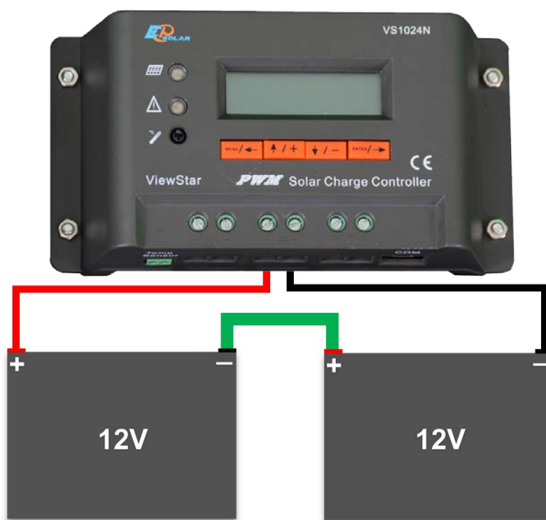
Figura 9.4 Dos baterías de 12V conectadas en serie
