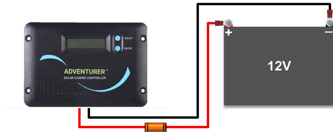
Figura 6.1 Controlador de carga conectado a una batería de 12V
