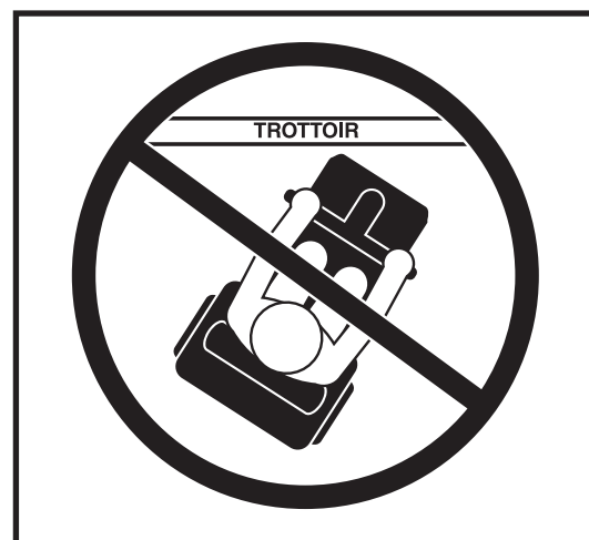
Figure 7. Approche incorrecte de trottoir
