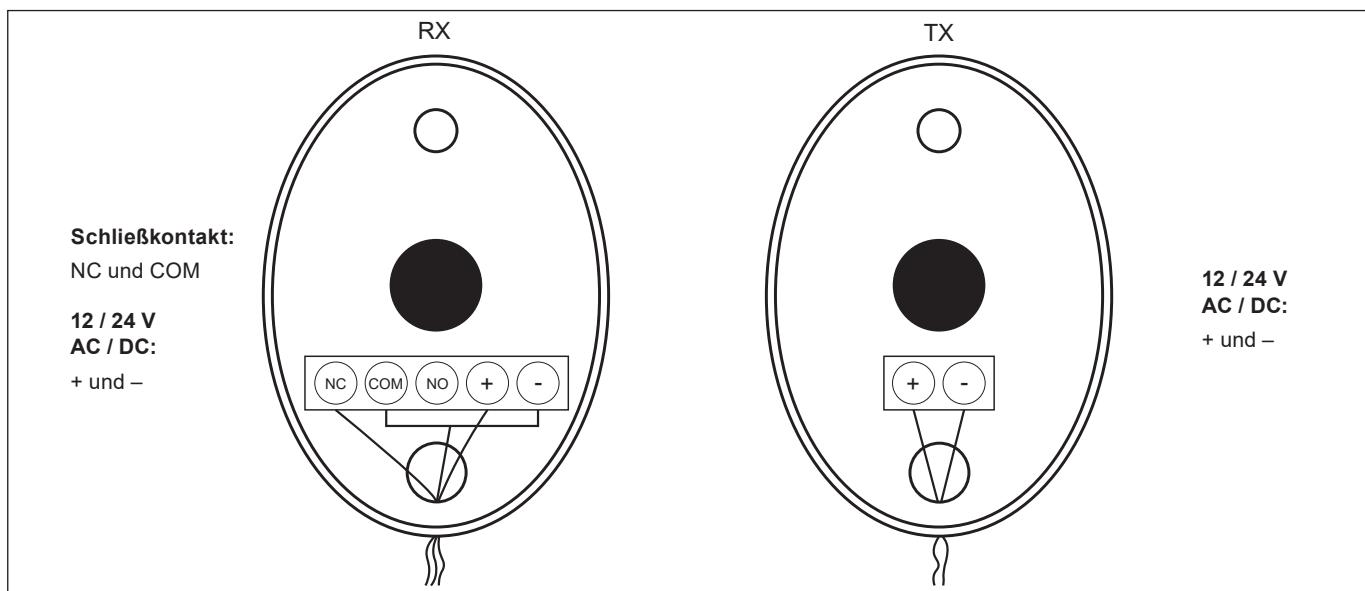
Brücke zwischen COM und – setzen.
