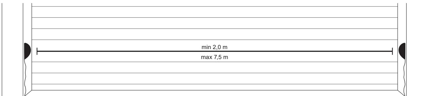
Sender und Empfänger **müssen** auf gleicher Höhe (20 cm) montiert werden.
