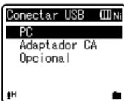
[PC]: Ajuste para cuando la grabadora se conecta al ordenador y se utiliza como dispositivo de almacenamiento o dispositivo compuesto. Conectado como almacenamiento o compuesto.
