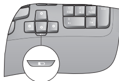
Témoin de charge des piles
