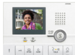
GT-1C Tenant Station
