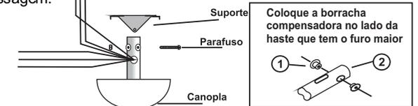
Coloque a borracha compensadora no lado da haste que tem o furo maior
