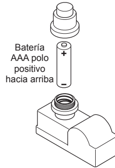
Figura 12 - Instalación de la batería en Ignitor
