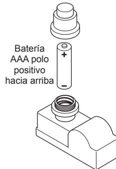
Figura 12 - Instalación de la batería en Ignitor
