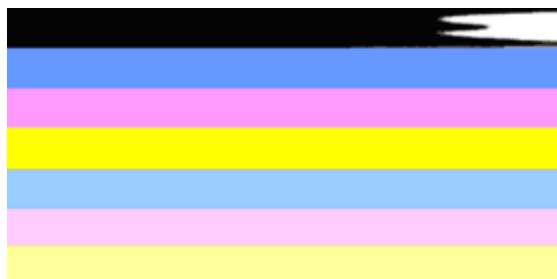
Esempio di Barre di colore scadenti - La barra superiore è striata irregolarmente o sbiadita
