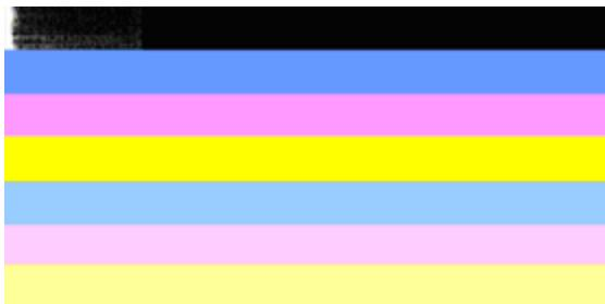
Esempio di Barre di colore scadenti - La barra nera superiore è imperfetta ad un'estremità.
