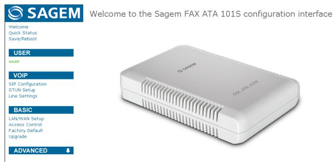
C'è la possibilità di attribuire un indirizzo IP (fisso o dinamico) attraverso un server DHCP al porto WAN di Sagem Fax ATA 101S grazie all'interfaccia di configurazione web.
