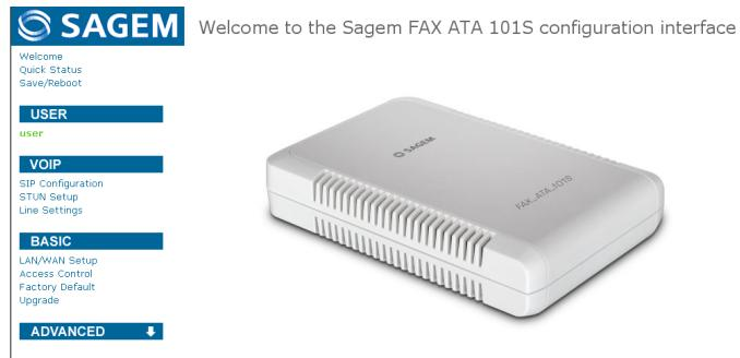
Anschließend können Sie dem WAN-Anschluss des Sagem Fax ATA 101S über die webbasierte Benutzeroberfläche eine IP-Adresse zuweisen (als feste Adresse oder dynamisch als DHCP-Serverlease).
