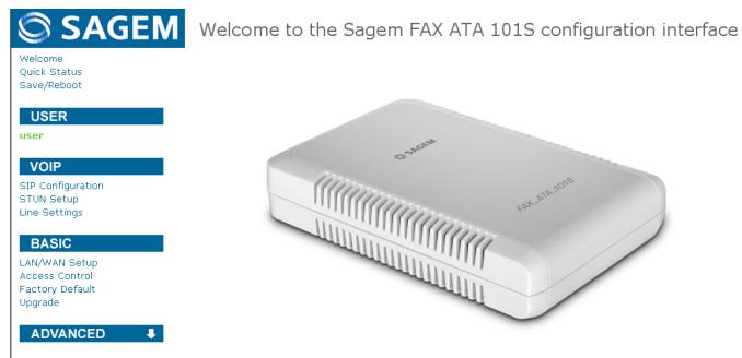
Poderá então atribuir um endereço IP (fixo ou dinâmico através de um servidor DHCP) à porta WAN do Sagem Fax ATA 101S pela interface de configuração web.
