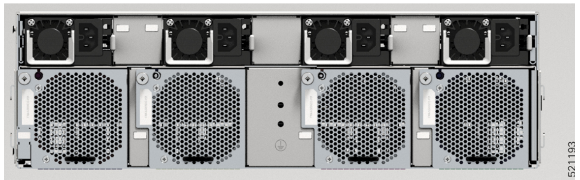
Illustration 4 : Panneau arrière du routeur Cisco ASR 9903
