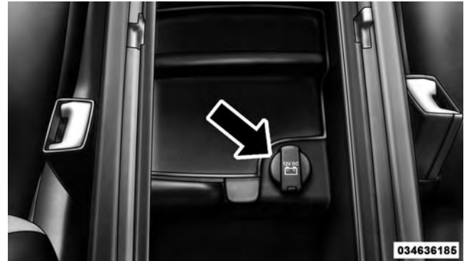
Center Console 12 Volt Power Outlet
