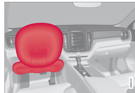
Airbag del volante y airbag de rodillas 1 en el lado del conductor del asiento delantero.
