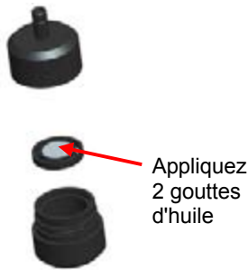
Figure 4-4 : Appliquez 2 gouttes d'huile sur la plaque de l'impacteur
