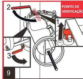
1. Levante a placa de travamento da manopla da válvula de isolamento.
