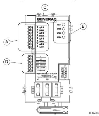
Figure 2-2. Smart A/C Module (SACM)
