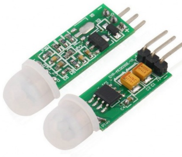
Figure 2-2. HC-SR505 Mini PIR Sensor
