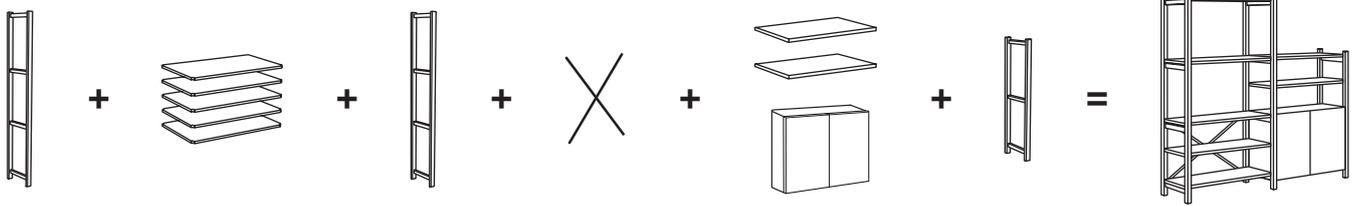
Zuerst solltest du darüber nachdenken, was und wie viel du unterbringen möchtest. Kombiniere die Seitenteile mit Einlegeböden. Für das erste Element brauchst du zwei Seitenteile, einen Satz Einlegeböden und ein Stütz Kreuz.
